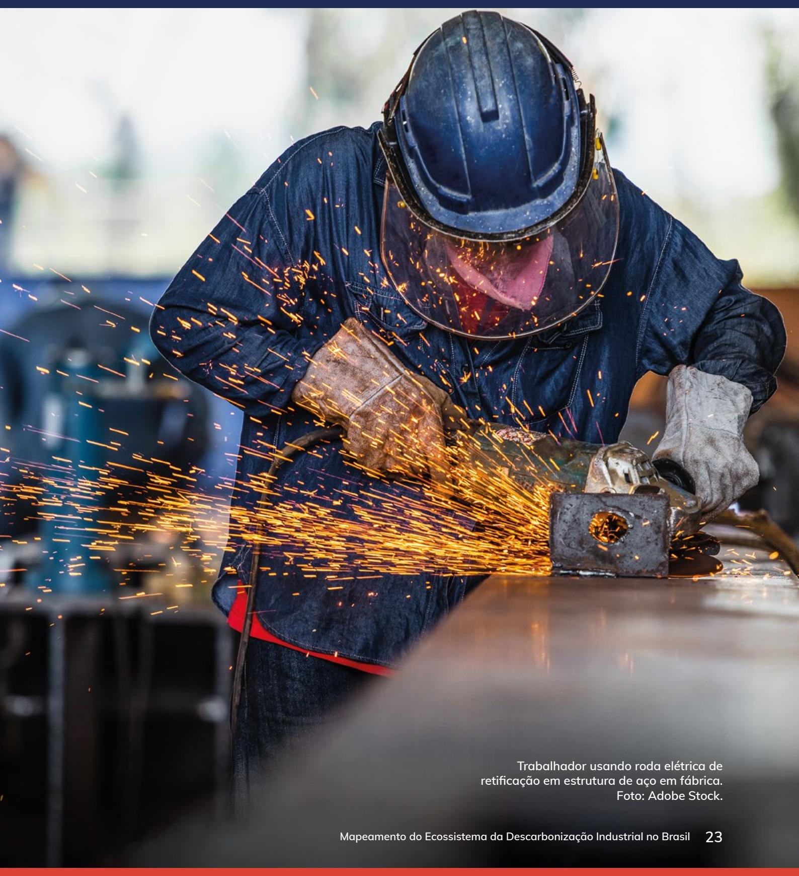
Trabalhador usando roda elétrica de retificação em estrutura de aço em fábrica.
