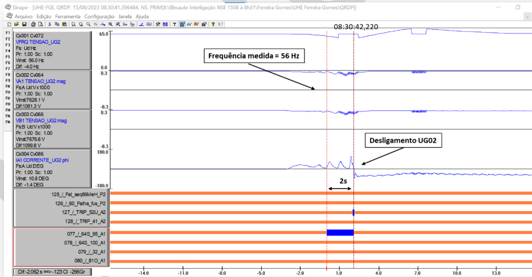
Figura 145 - Atuação da proteção de subfrequência da UG02 da UHE Ferreira Gomes
